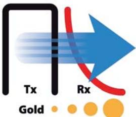
MPF (Multi Período Rápido) incorpora tecnología extremadamente rápida Inducción de pulso entre transmitir (Tx) y recibir (Rx) señales del detector. Por lo tanto transmitir señal residual mínima está presente durante el ciclo, que permite detectar claras, nítidas de oro muy pequeñas.
